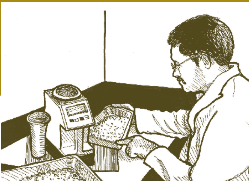
Contrôle de la teneur en humidité des semences
