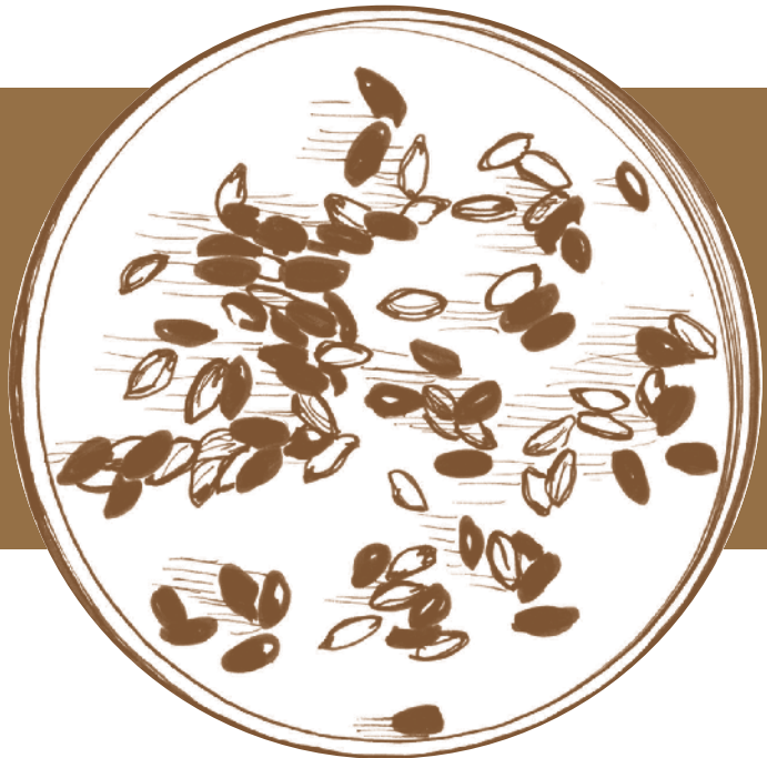
Figure 3.15 Dans le test du phénol, les variétés de blé développent une couleur caractéristique allant du brun pâle à très foncé
