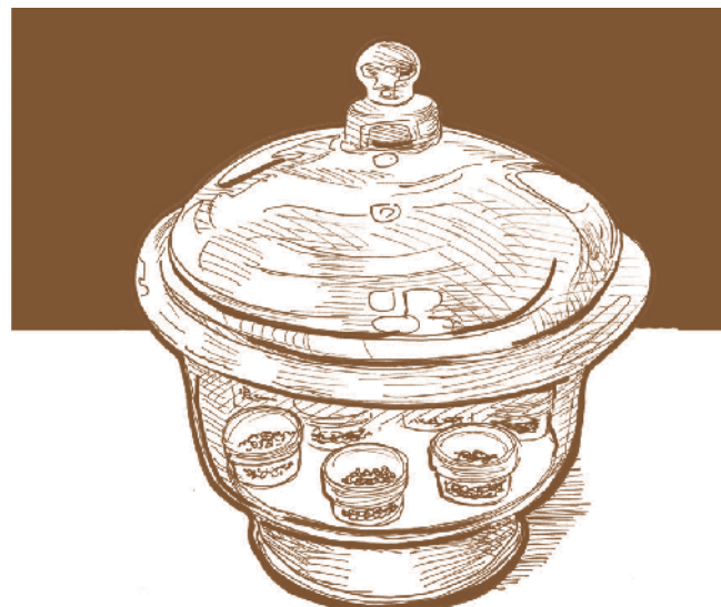
Figure 3.12 Test d'humidité - Séchage des semences dans le four (gauche) et refroidissement dans un dessiccateur (droite)
